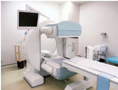
ガンマカメラ ガンマ線を放出する薬品を用いて、目的とする病変や臓器・器官の状態を調べる装置です。
