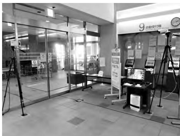
図6：更新した正面入り口のサーモグラフィーカメラ
